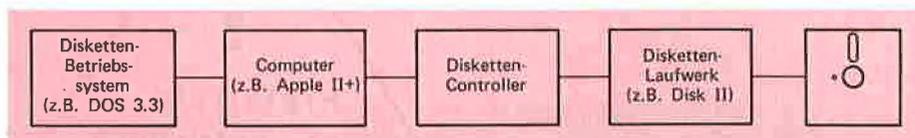
Bild 1: Übersicht über ein Diskettensystem
