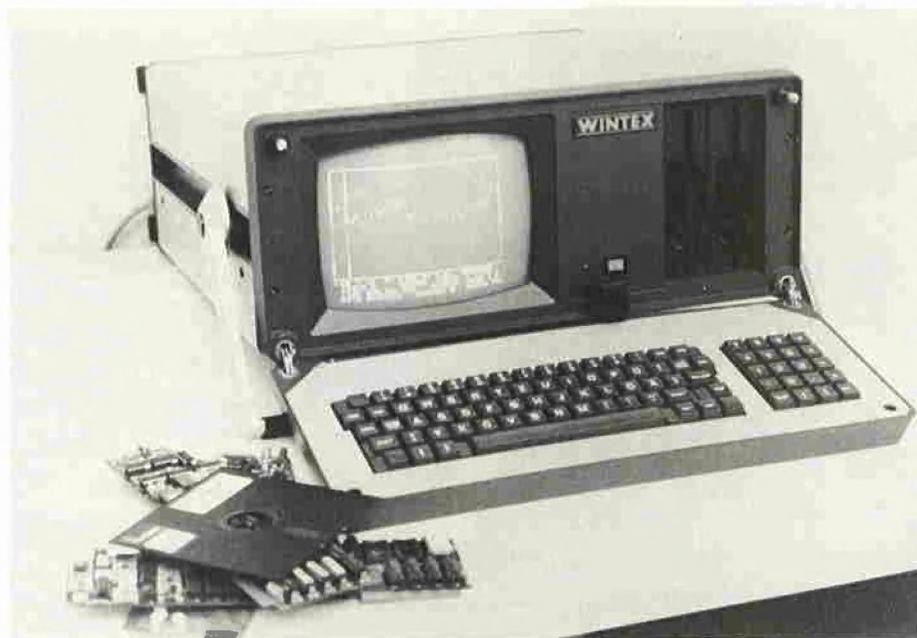
Bild 5: Transportables, digitales Speicheroszilloskop
